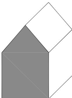
La deuxième montre l'objet en fonction d'un angle. Toutes les faces seront déformées. C'est la **perspective axonométrique**.
