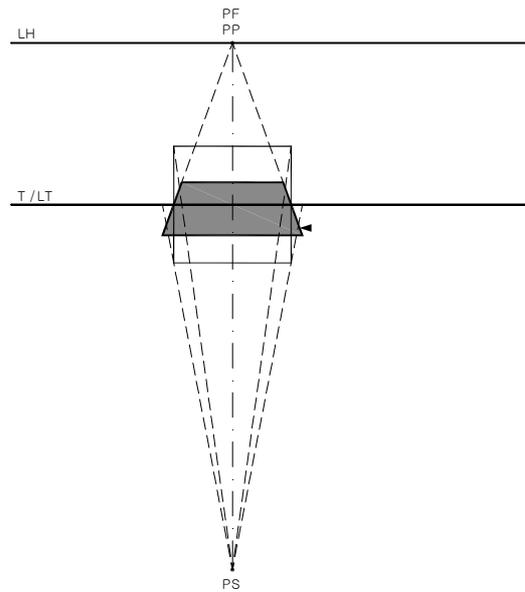
Ici, on aménage une zone de dégagement entre T et LT. Le plan et la perspective ne sont plus l'un sur l'autre, ce qui rend le dessin plus lisible.
