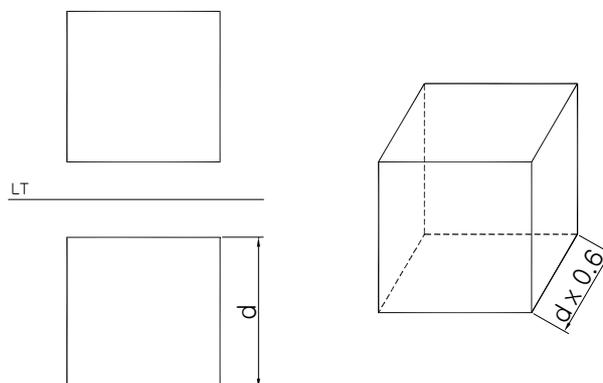
NB. : Le tracé d'une perspective cavalière à 45° est très facile sur un papier quadrillé. Un carré de 1 cm de côté a une diagonale de 0,7 cm.
