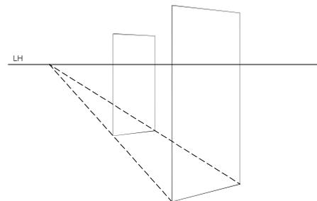
Les largeurs semblent se réduire et les hauteurs semblent diminuer en s'éloignant du spectateur. Il s'agit de l'effet de **raccourcissement** et de **diminution**.
